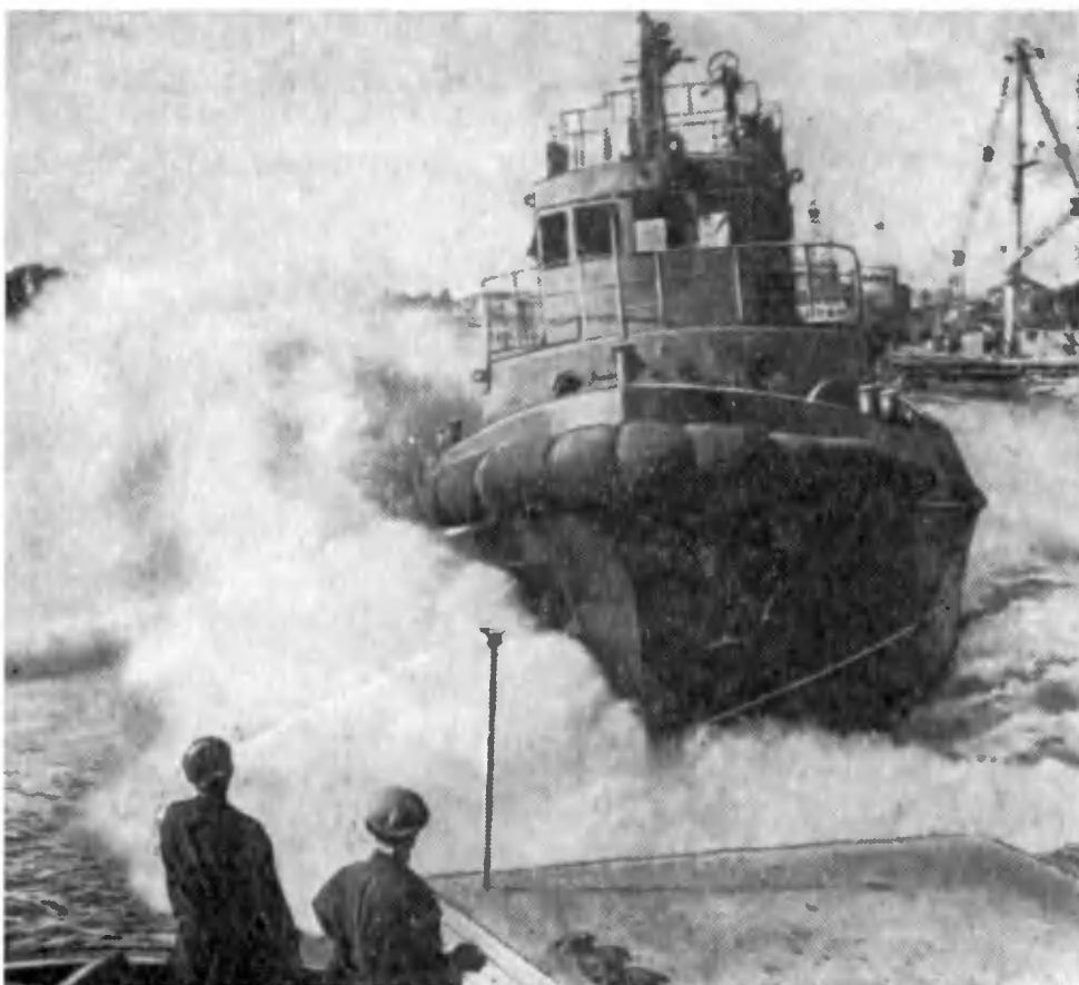
Боковой спуск портового буксира мощностью 1200 л. с.
