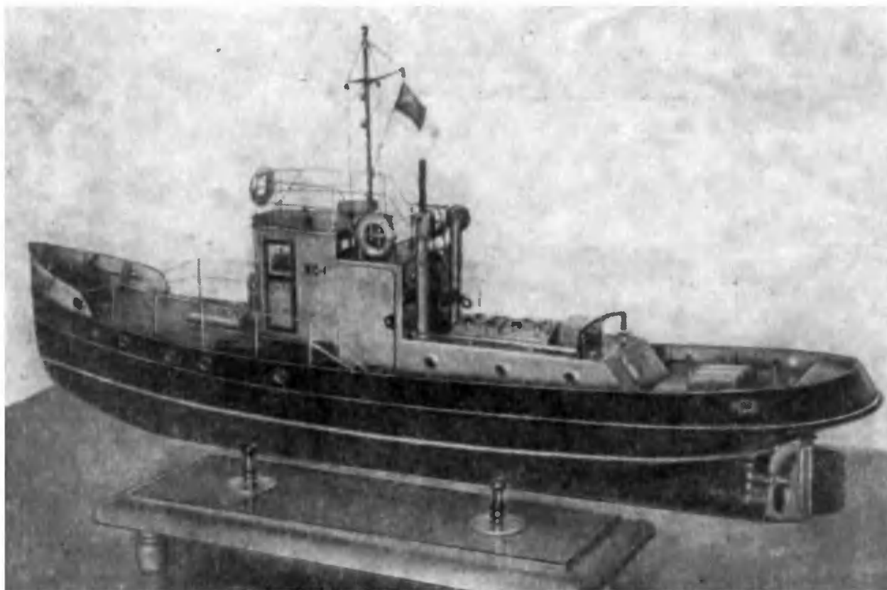
Рис. 1. Модель первого в СССР цельносварного судна — буксирного катера типа «ЖС».
